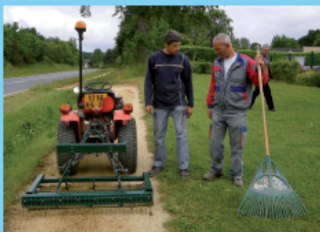
La Plourasette®, aujourd'hui brevetée, a été conçue par les agents de Plouër-sur-Rance pour un traitement mécanique des espaces verts en remplacement des produits phytosanitaires. – © Mairie de Plouër-sur-Rance
