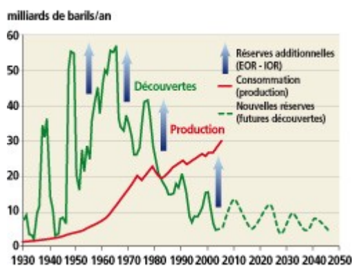
Fig. 2 : Courbes comparées des productions et des réserves pétrolières : la différence est croissante entre la production pétrolière mondiale et les découvertes additionnelles.
